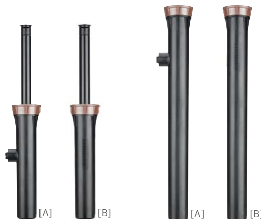
[A] PROS-06-SI-PRS30* [B] PROS-06-PRS30* Altura retraído: 22,5 cm Altura emergente: 15 cm Diámetro expuesto: 5,7 cm Tamaño de la entrada: ½"
